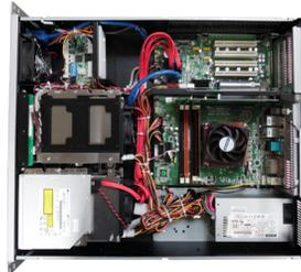
Câblage optimisé pour une meilleure gestion des flux d'airs et de la dissipation thermique
