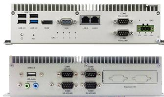
Connectiques entrées/sorties multiples et variées dans un châssis compact
