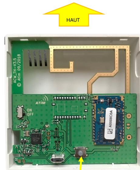
**Pour mettre le produit sous tension, appuyez sur le bouton poussoir pendant 5 secondes**
