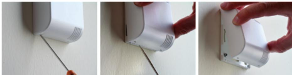
\* Il est impératif d'ouvrir le boîtier par le bas ; l'ouverture par le haut pouvant endommager le circuit.
