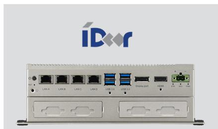
Intégrez rapidement de nouvelles fonctionnalités grâce aux 4 modules iDoor accessibles avec l'ajout d'un stack additionnel (option).
