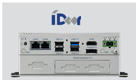
Intégrez rapidement de nouvelles fonctionnalités grâce aux 2 modules iDoor accessibles avec l'ajout d'un stack additionnel (option).
